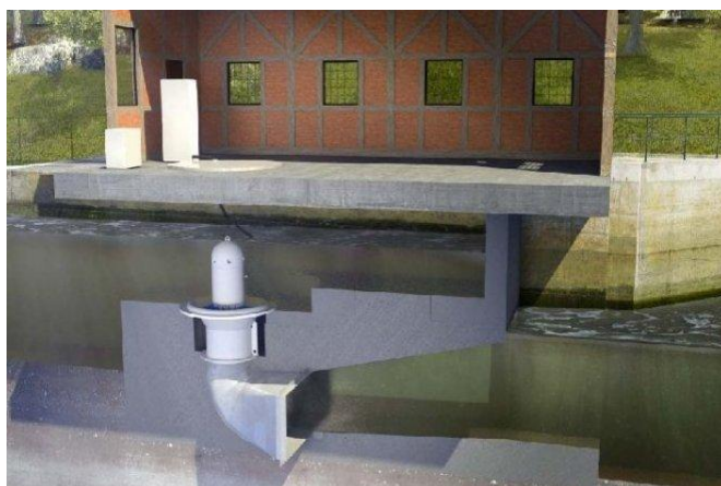
Рис. Г.5 – Вертикальне та горизонтальне розташування гідротурбін StreamDiver™ 138
